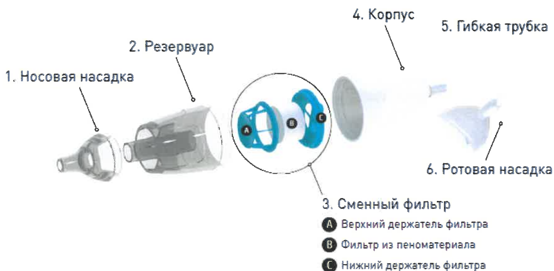
Рис. 1. Составные части аспиратора назального «Аквалор® беби»: носовая насадка (1) многократного пользования, специально адаптированная к анатомическим особенностям детского носа; резервуар (2), предназначенный для сбора слизи; сменный фильтр (3), облегчающий аспирацию; корпус (4), оснащенный эргономичной частью для удобного захвата рукой; длинная гибкая трубка (5); ротовая насадка (6)
